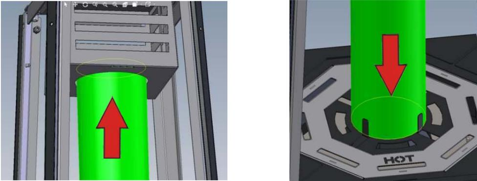
Führen Sie zuerst die Glasröhre etwas schräg in die Topbox ein. Dann lassen Sie die Röhre nach unten in die vier Laschen gleiten.
