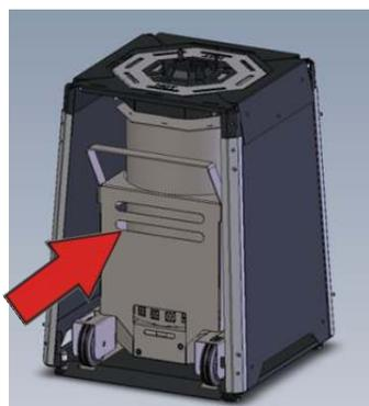
Warten Sie 15-20 Sekunden und schieben Sie dann den Brennerwagen in das gerät bis die Räder fest sitzen (innerhalb einer kleinen Stufe im Geräteboden).
