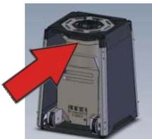
Rund um die Düse ist eine Brandschutzmanschette angebracht. Sorgen Sie dafür dass diese nicht beschädigt ist (nicht zu grob aus und einfahren).
