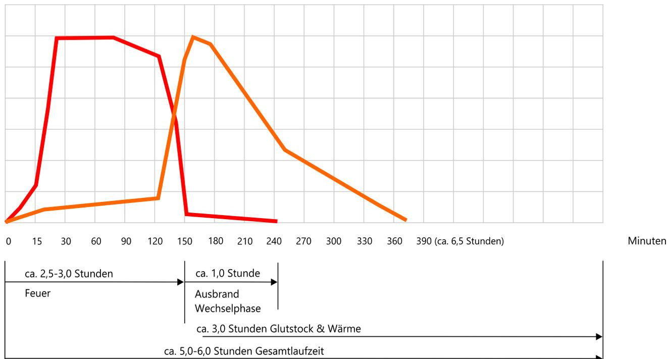
Oben beschriebenes Diagramm gilt bei voller Befüllung sowie einer Referenz-Aissentemperatur von 20 Grad.
