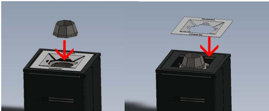
Stecken Sie die Düse von oben gerade in die dafür vorgesehenen Schlitze des Brenners.
