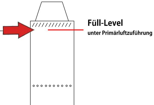
Mit dem Füllset ist es sehr einfachen den Brenner zu füllen. Stecken Sie den Fülltrichter in den Brenner und befüllen Sie diesen mit dem vollen Messbecher. Der Inhalt des Messbechers entspricht genau einer Brennerfüllung.
